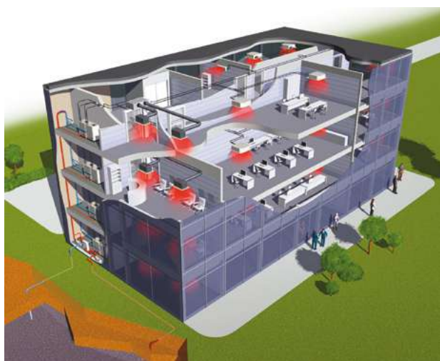
Système Réversible sur géothermie
